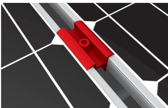
Entre deux modules utiliser deux étriers intermédiaires universels OneMid. Clipser l'étrier dans la rainure du rail et fixer l'étrier au cadre du module.
