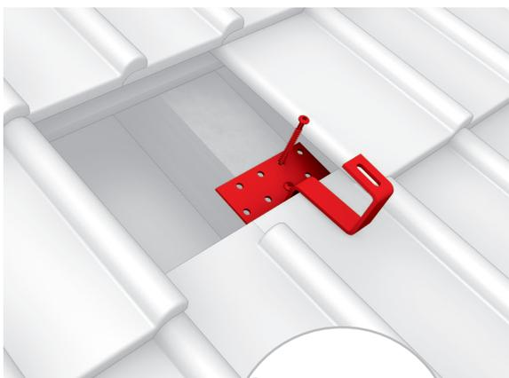
Le crochet doit être fixé sur le chevron en utilisant au moins 2 vis en acier inoxydable pour construction en bois (au moins une vis doit être prévue pour chaque rangée de trous). Le dimensionnement et la position des vis sont à effectuer conformément à la réglementation en vigueur. Cette méthode de fixation doit également être employée dans le cas d'une isolation sur toiture ou d'un contre-lattage. Ajuster le crochet à l'horizontale pour le positionner dans la partie creuse de la tuile.
