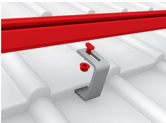
Le Rail de montage est fixé sur le crochet à l'aide du vis à tête marteau et Ecrou à embase avec cran d'arrêt K2. Couple de serrage 35 Nm.
