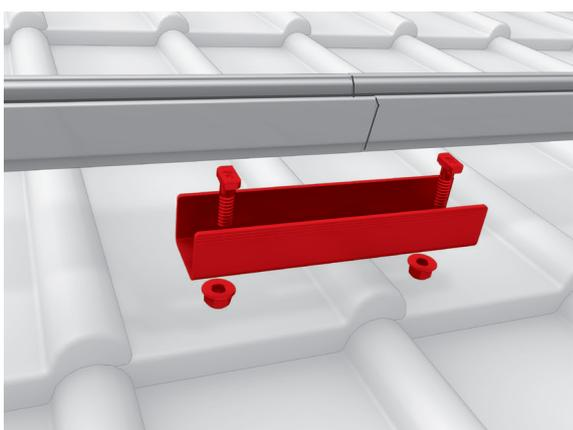
Poser les rails bout à bout et assembler à l'aide du connecteur de rails et des 2 vis à tête marteau et écrous à dents. Le joint entre les rails ne doit pas être situé dans la zone du crochet de toit. Couple de serrage 35 Nm
