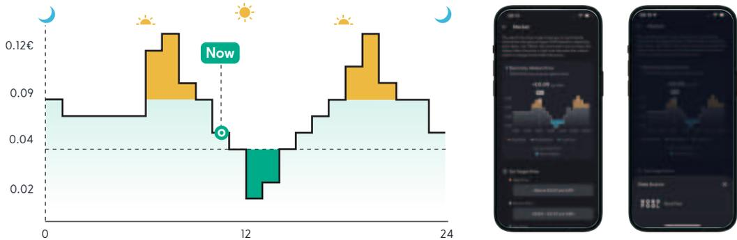
En surveillant activement les prix de l'énergie à J-1 y réagissant, Hyper garantit des économies maximales. L'APP de Zendure intègre au prix de gros de l'énergie fixés à J-1 de Nord Pool, fournissant des informations qui permettent de réduire les coûts énergétiques en fonction au moment d'utilisation.
