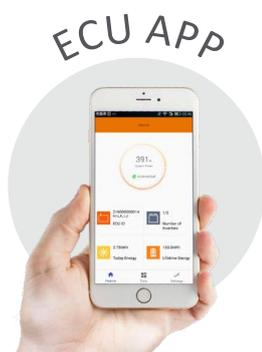
Téléchargeable gratuitement sur APP Store et GOOGLE Play, l'ECU APP d'APsystems devient l'interface de l'ECU-B, l'ECU-R ou l'ECU-C permettant une configuration et un paramétrage rapide de l'installation pour une mise en service facilitée.
