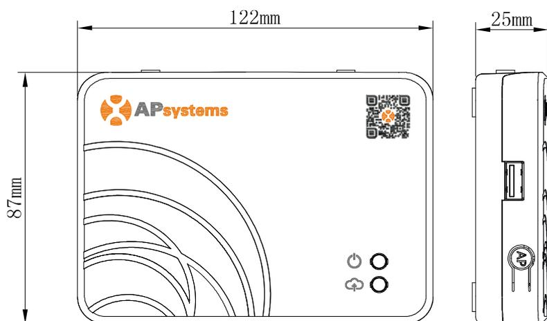
La nouvelle passerelle de communication ECU-B d'APsystems fonctionne avec les micro-onduleurs APsystems. Elle permet la collecte et le transfert des données de production de chaque module en temps réel jusqu'à 4 modules PV. Utilisant ZigBee comme protocole de communication rapide et robuste, cela vous offre une complète visibilité à travers un monitoring détaillé et un contrôle du bon fonctionnement de chaque module pour une installation solaire à la performance maximale.
